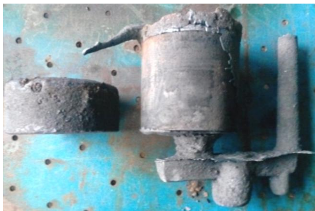
Рис. 2. Внешний вид экспериментальной отливки с литниково-модифицирующей системой
